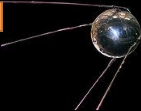
Il s'agissait d'une petite sphère d'aluminium de 58 centimètres de diamètre, pesant 83,6 kg dotée de quatre antennes, après avoir fait 1 400 orbites autour de la Terre et parcouru environ 70 millions de kilomètres, **Spoutnik** est rentré dans l'atmosphère où il s'est consumé le 4 janvier 1958.
